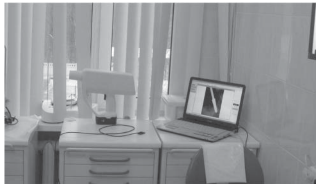
Рис. 3. Портативный рентгеновский аппарат «Пардус» позволяет исследование непосредственно во время операции стоматологической имплантации. Цифровой датчик подключен к ноутбуку со специализированным программным обеспечением.
